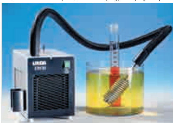
Охлаждение с помощью погружного охладителя LAUDA ETK 30
