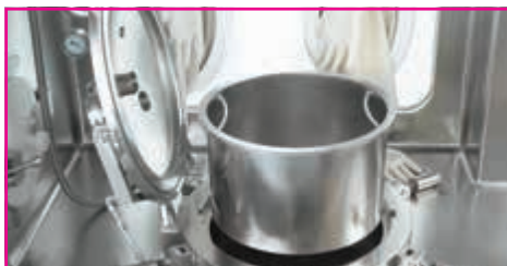
Друк-/нутч-фильтр со съемным фильтром, объединенный с главбоксом.
