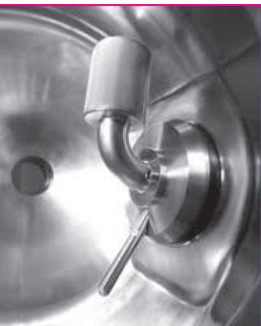
Внутренняя часть барабана, отвечающая стандартам GMP, с фильтром и датчиком температуры.
