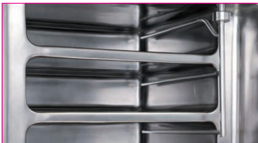
Манифолд: вертикальная труба с отводами, подающими газ в камеры. Используется для заполнения камеры инертными газами или для вентиляции.
