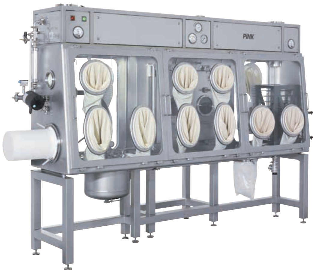
Друк-/нутч-фильтр со съемным фильтром, объединенный с главбоксом.
